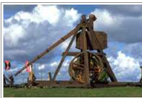
Prinsippet i slyngekasterne [på dansk: «Bliderne»] er det samme som i en håndslunge. Ved hjelp av en kasse med ballast av sten eller ved håndkraft, vippes kastearmen frem, og prosjektilet som er plassert i en slyngepose i enden av kastearmen, slynges frem.
